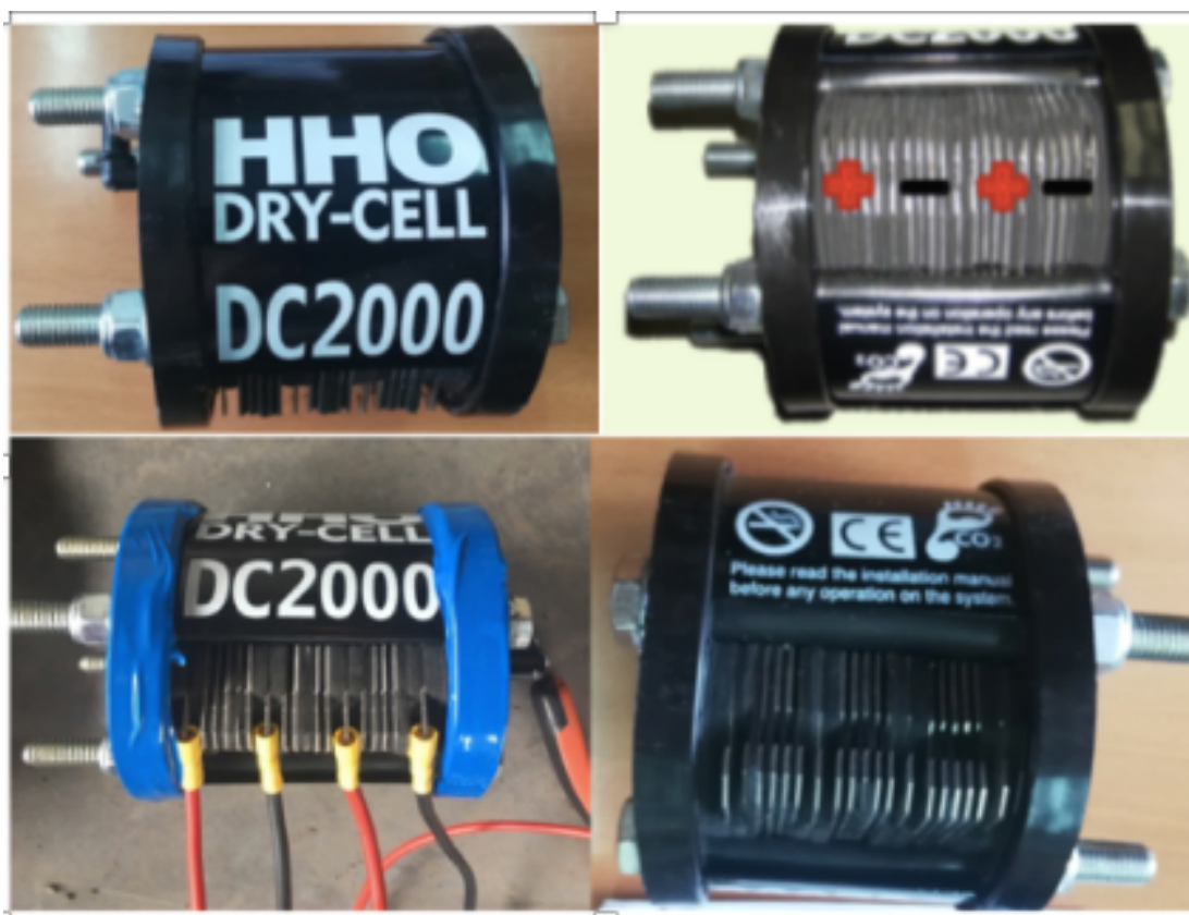
Рисунок 4.13 - Электрическое соединение контактов ННО где красный провод: плюс(+); чёрный провод: минус(-)
