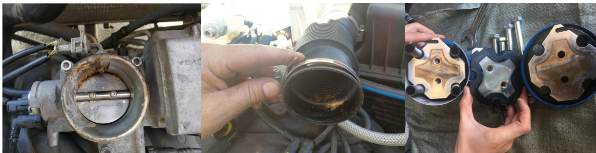
Рисунок 4.18 - Накипи системы ВГ и очистка ВГ
