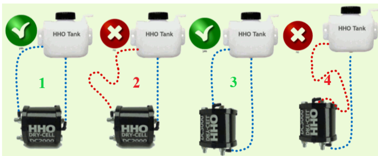
1,3--Правильная установка; 2,4--Неправильная установка Рисунок 4.10 - Установка ёмкости для воды и шлангов для системы ННО
